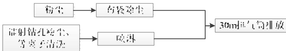
图 1.1-15 粉尘、等离子清洗废气处理工艺
